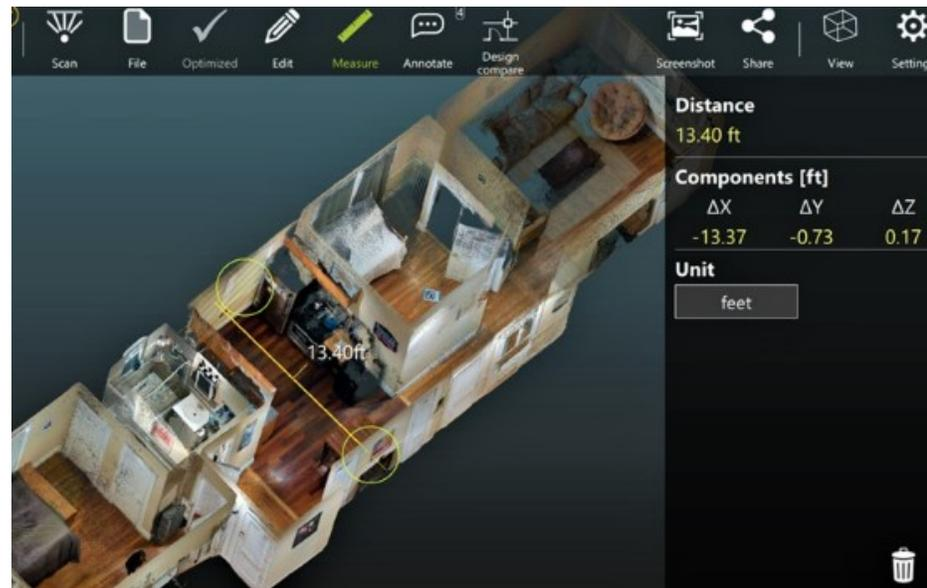
Il sistema è in grado di ottenere un rilievo a nuvola di punti con valore RGB di alta qualità con un sensore calibrato fino ai 3,3m e una precisione di 2mm, sia per gli ambienti interni che per gli ambienti esterni.
