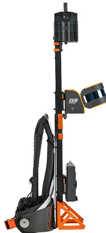
Con gli strumenti del marchio Geo Slam siamo in grado di acquisire in movimento e creare modelli 3D estremamente precisi per ambienti outdoor, indoor e anche in assenza di segnale gps.
